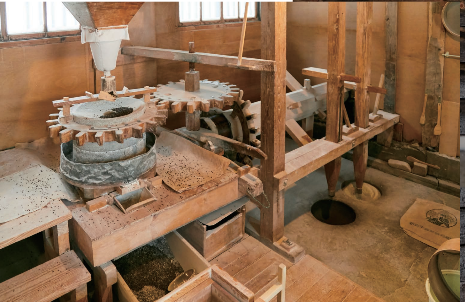
水車小屋の内部。手前の石臼で玄そばを挽き、篩にかけて残った甘皮などを床に穿たれた搗き臼に移し、杵で搗く。太い心棒を回すのは奥の壁の外側にある水車でそば本来の風味を引き出す 水車の力で挽いた粉
