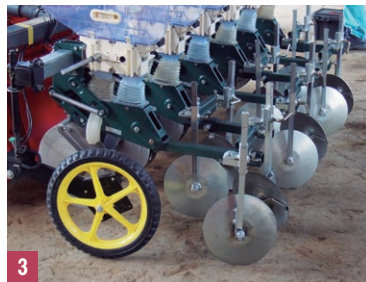
小畦立て播種技術を用いたソバ畑(1)。慣行農法によるソバ畑(2)に比べると、生育のよさがわかる 3 従来の播種機に装着して使う「小畦立て播種装置」
