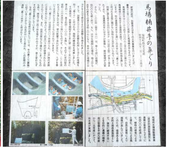
馬場補井手の鼻ぐり。下が模型で左下が現在。かつては手入れもされずに草がぼうぼうとしていたので、見るために降りていくのも命がけだったと言う（左上の写真は岡裕二さん提供の当時の写真）。台地の下だから、ヨナ（火山灰の堆積物）が溜まると手入れができない。そのため水路を掘る際に、隔壁を設け牛の鼻ぐりのような穴を開けて、底の流速が増すことを利用してヨナを排出させた。恐るべし、加藤清正。
