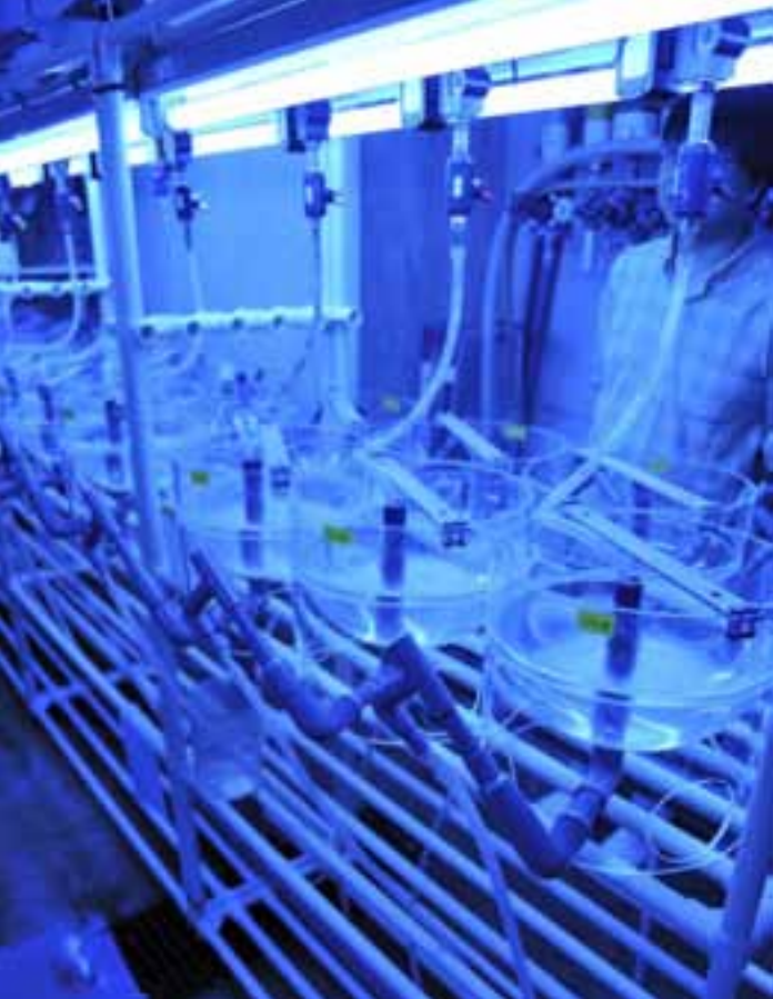
世界で初めて、ウナギの人工生産に成功した養殖研究所。この成体も、人工生産で育ったものだ。非常な手間をかけてつくられるため、コストがかかり過ぎて、まだ市場に出回るまでには至らない。左は、水の汚れに弱いウナギの幼生プレプトセファルス、新しいきれいな水槽に移すための装置。サイフォンの原理を利用して、移し変えている。青い照明なのは、プレプトセファルスの生育環境である深海に似せているため。
