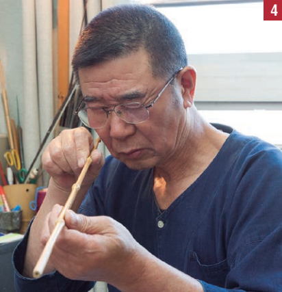
1 三ツ木さんのお店の2階に展示されている江戸和竿 2 三ツ木さんが釣り大会で優勝したときに用いた手製のキス竿 3 平やすりで竹を削って継ぎ目を合わせる 4 竹の曲がりや膨らみ具合を見る三ツ木さん。竹は必ず曲がっているので温めて矯正したり、削ったりする作業が欠かせない
