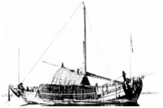
明治中期のバイ船（福井県河野・磯前神社蔵）掲載した『海事史研究』第9号の解説者石井謙治氏によれば、福井県の有名な北前船船主右近権左衛門の持ち船八幡丸だという。船の横腹に伝馬船が寄り添っている。1,500石積か2,000石積の大船で、帆柱や帆桁の巨大さが水夫と比較してよく分かる。（ ） （ ）写真は、井本三夫『北前の記憶』桂書房 1998年より引用。
