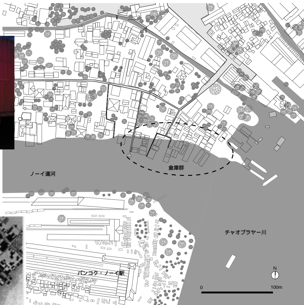
上：ノイ地区屋根伏図。かつては対岸の駅と結びついた物流の拠点であった。倉庫群は水中に杭を打つ高床でつくられ、水上と陸上の両性的な性格を持つ。倉庫群を含め、家屋や道の下は水面や低湿地であるため、水際線は雨季と乾季では全く異なり、一定しない。
