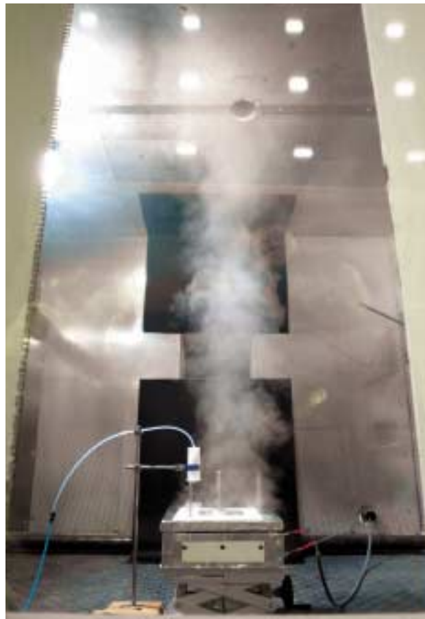
上：実験設備の閉鎖空間に、蚊取り線香で煙を溜め、熱した鉄板に放水した。瞬時に水蒸気が発生し上昇するとともに、天井近くに溜まっていた煙が下降するのが目視できた。実際の火災現場には、この何倍もの熱と煙が充満していると思うと、大変恐ろしくなる。
