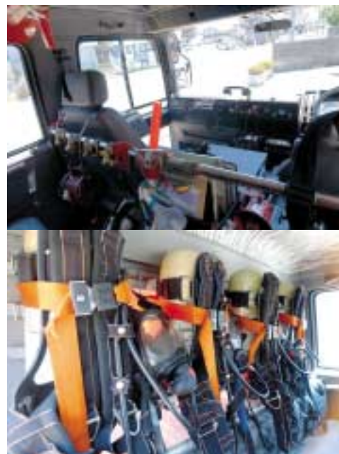
川西市のポンプ車の積み荷を見せてもらった。ドライバー側の積載品が、すべて救急（レスキュー）にかかわるものだったのには、驚かされた。消防の用具は、座席の背後とナビゲーター側に積まれていた。
