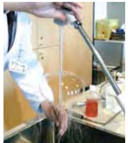
水を小さな円盤の上に打ちつけているだけだが、水が互いに引き合う表面張力のおかげで、弧を描いて滴り、見事な球形を造り出す。
