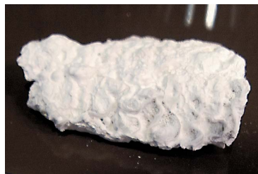
上：温泉井戸の管内に付着したり、沈殿した湯垢（スケール）。
