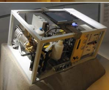
右：日本館は人気が高く、長蛇の列が続く。空のカーテンが意外にも暑さを凌いでくれた。上：ドイツ館、ベルリンでの伏流水取水の模型。中：地下水に酸素を注入して分解を促進する技術の説明パネル。左：コンテナ状に組み込まれた非常用淡水化装置。
