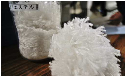
下：水槽に循環させる海水の濾過材。
