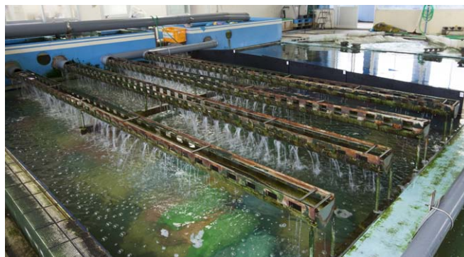
25m プールを20mのところまで仕切り、奥の5mはろ過装置のスペース。ろ過は大まかに次の3段階を経る。①軽石、サンゴ砂、活性炭でふんをろ過、②生物ろ過槽でアンモニアを除去、③オゾン水中に吹き込んで滅菌という完全循環式だ。水温は22〜23度が適温で、冬はボイラーで水を温める
