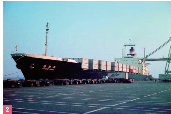
2 現代の暮らしを支える大型コンテナ船。日本の貿易量の99.6%は海上輸送が担っている 2 日本初のコンテナ船「箱根丸」。1968年(昭和43)8月、三菱重工神戸造船所で竣工し、カリフォルニア航路に就航(112提供:日本郵船株式会社)
