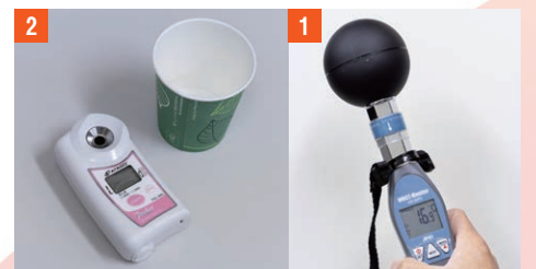
1暑さ指数を測定する電子式装置。屋外ではこの黒球が付いたものを用いるとより正確に測れる 2競技者の体調管理に用いる尿比重屈折計。尿を滴下するだけで尿比重(脱水レベル)がわかる
