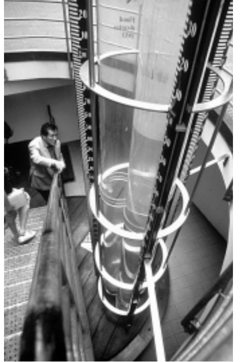
上：現在も川の水位が常に監視されている、市庁舎の内部。
