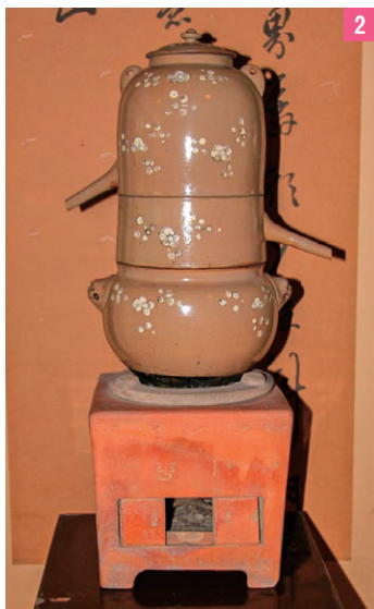
2 ランビキと焔炉（こんろ）。ランビキは江戸時代に薬油や酒類などを蒸留するのに用いたが、船に運び込んでも使われたとされる 村上医家史料館蔵
