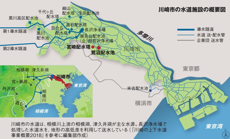
川崎市の水道は、相模川上流の相模湖、津久井湖が主な水源。長沢浄水場で処理した水道水を、地形の高低差を利用して送水している（「川崎の上下水道事業概要2018」を参考に編集部作成）
