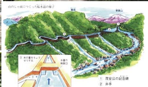
上：ところどころ水路の側壁を低くして、一定以上の水をオーバーフローさせる仕掛けを野越しという。蛤水道は福岡藩の水を佐賀藩が分水嶺を越えて横取りしたもののだが、取り過ぎないように野越しを越えた水は那珂川に戻るようになっている。（27ページ参照）
