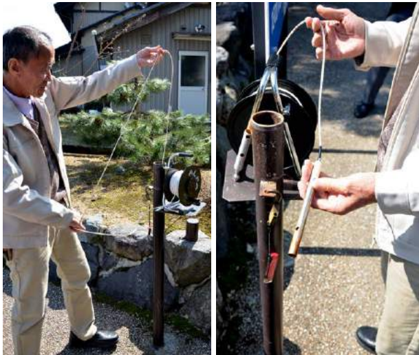
杉本さんが毎朝地下水位を図る「手計り計測器」。金属製のセンサーを管のなかに差し込む。センサーが着水すると音が出るため、水位がわかる。水位は刻一刻と変化しているという
