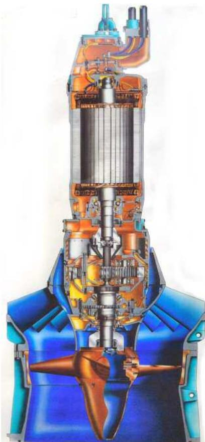
水中タービン発電機構造模式図
