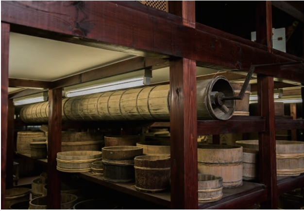
長細い水上輪(上段)とさまざまな大きさの桶類。いずれもかつて佐渡で用いられたもの。水上輪は佐渡金銀山で開発されたが、その後は農業でも使われた(佐渡国小木民俗博物館蔵)
