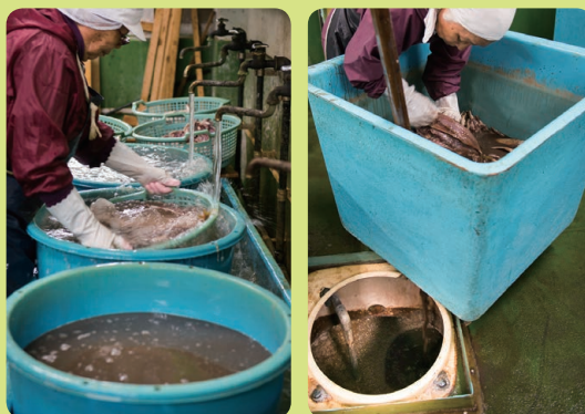
(右) 漬けた液は捨てずに地下のタンクに戻す (左) 魚は3段階に分けて地下水で丹念に洗う
