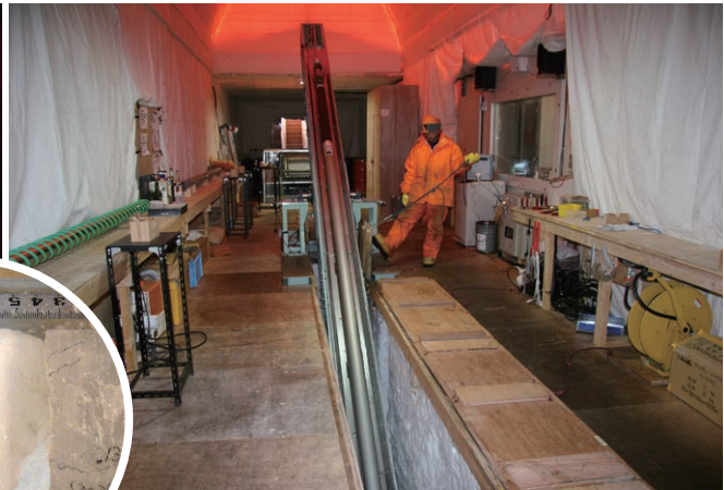
コアを取り出した12m長のドリルを立てる作業。この後、ウィンチで掘削孔のなかに下ろす。3.5~4mの掘削ごとに「ドリルの引き上げ」、「コア取り出し」、「孔底へのドリル下ろし」、「コア掘削」を繰り返す
