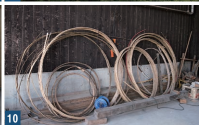
7 高台(碓石山)から見た「醬の郷(ひしおのさと)」と草壁港。しょうゆや佃煮をつくる工場が軒を連ね、歩くとしょうゆの香りが漂う。後背地にはしょうゆづくりに欠かせない水をもたらす山々がそびえる 8 ヤマロク醤油が木桶で製造する「菊醬」(右)と「鶴醬」(左) 9 新蔵のなかに並んで仕込みを待つ新しい木桶。1本の重さはおよそ500kg 10 島内で探し歩いて見つけた真竹で編んだ竹たが 11 側板には吉野杉を使う。外圧に対して「しなる」強さがあるという 12 2019年に竣工した新蔵の外観
