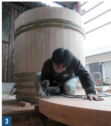
123 木桶づくりの作業風景。編んだ竹たがで側板を締め、底板にかんなをかけるなど数多くの工程がある。「木桶職人復活プロジェクト」には120名が加入し、毎年少しずつ増えている（提供：ヤマロク醤油株式会社）4 山本さんたちが初めてつくった木桶。3年ほど前、材が乾いて上部にすきまができたものの、放っておいたら自然にふさがり、そこに菌が棲みついた5 木の階段を上って木桶の上に出る。日あたりや風通しが異なるため、桶一つひとつで微妙に味が違うという6 ヤマロク醤油の五代目、山本康夫さん
