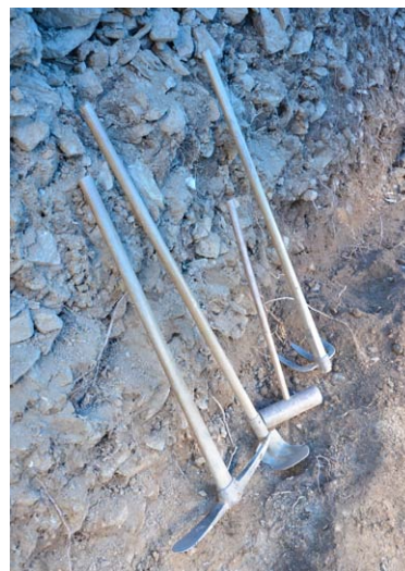
石積みで用いる道具(手前からツル、ほっぱかき、玄翁、熊手)。ツルは床掘りで、ほっぱかきは土を寄せ集めるときに、玄翁は石を割ったり整えたりするとき、熊手は土を掘ったりほぐすときに用いる
