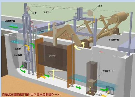
自動水位調節扉(上下流水位制御ゲート)
