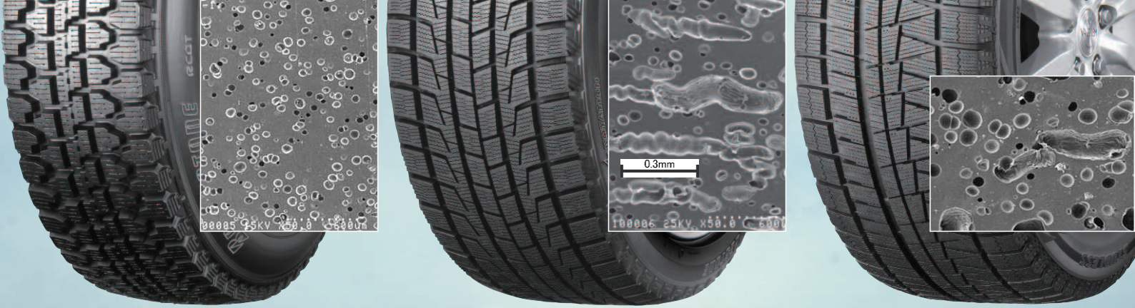
左から：1988年（昭和63）発泡ゴムを初めて採用したスタッドレスタイヤ。ゴムの中に同じぐらいの大きさの気泡が入っている／2003年（平成15）の製品。太い水路を採用したことが特徴だ／2009年（平成21）の製品。気泡と水路が、摩耗時に連結して氷上の水膜を効果的に取り除く。
