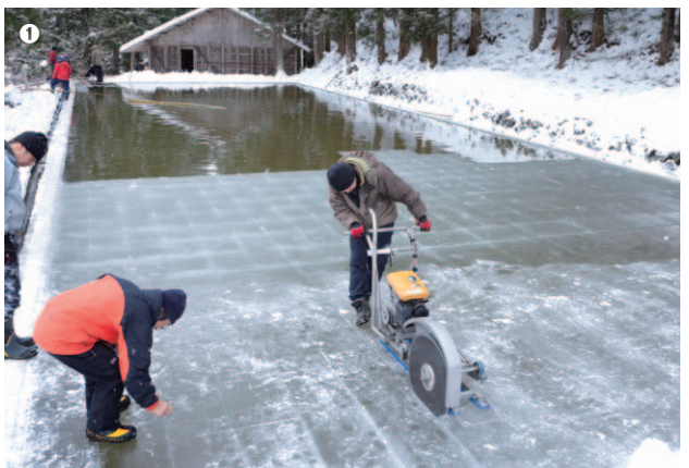
右:天然の氷づくりを継承した四代目徳次郎さん ①前日に引いたラインに沿って氷を切り出していく ②切り出した氷は竹のレールで滑らせながら運ぶ。氷の重さは約40kg ③氷が運び込まれる前の水室。壁板、床板も地元の杉材。床板の下は砂利で水分を逃がす ④水室に運び込まれた氷。大鋸屑をかけることで1年以上保管できる ⑤ゴミをとるためだけに凍らせ、表層に張った水ごと捨てるので不純物が少なく透明感に優れている
