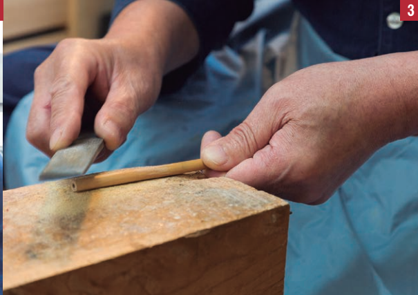
1 三ツ木さんのお店の2階に展示されている江戸和竿 2 三ツ木さんが釣り大会で優勝したときに用いた手製のキス竿 3 平やすりで竹を削って継ぎ目を合わせる 4 竹の曲がりや膨らみ具合を見る三ツ木さん。竹は必ず曲がっているので温めて矯正したり、削ったりする作業が欠かせない
