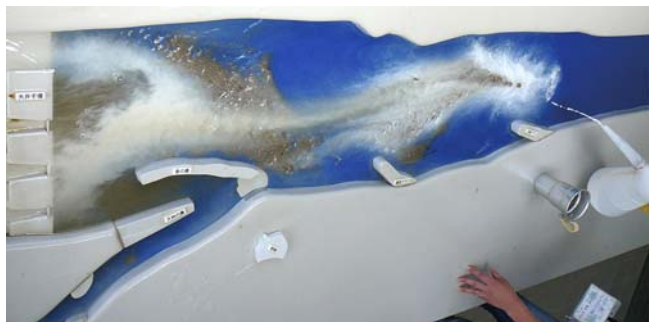
下：模型実験でも、沈砂作用が証明される。復元された石井樋帯は公園となっており、「さが水ものがたり館」では佐賀平野の水について学ぶことができる。
