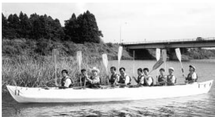
誰でも、簡単に楽しめるのがキーワードのEポート。10人乗りの手漕ぎポートだ。写真のEポートは、リサイクルペットボトルが原料。
