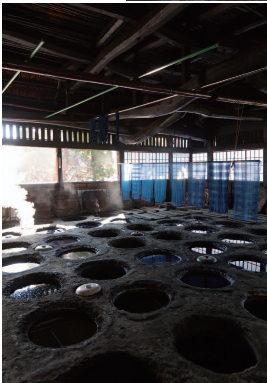
栃木県芳賀郡益子町にある「日下田(ひげた)藍染工房」の染め場。180L入る常滑焼の藍甕が72個並ぶ。藍甕に湯を張り、蓼藍からつくった薬、栄養分となるふすまや木灰などを入れると発酵が始まり、藍染めが可能になる。4個の藍甕の中央には「火床」と称する穴があり、籾殻などを燃やして温度を保つ。写真右は、藍甕にゆつくり布を浸けて色を染めている職人の小島卓磨さん(関連記事 pp.28-31)
