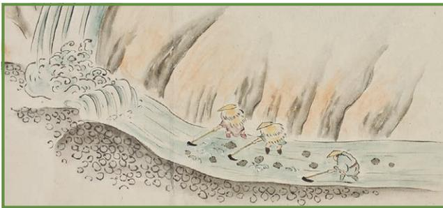
堤に溜めておいた水を一気に流して不要な土砂を洗い流す「大流」。砂金が効率よく採取できる
