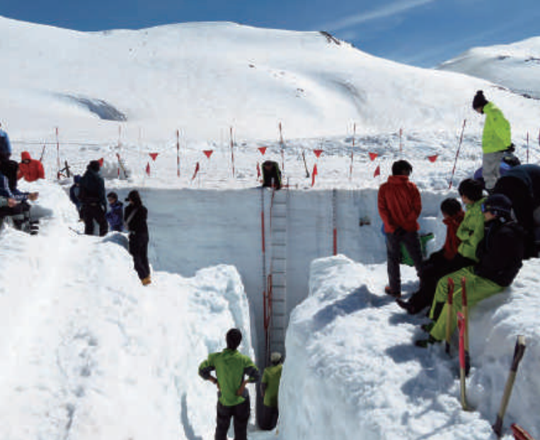
2018年4月に室堂平(標高2450m)で富山大学理学部の学生らが取り組んだ「積雪断面調査(積雪深:658cm)」。自然に積もった雪の深さや雪を水に換算した量、雪質、黄砂、大気汚染物質など地球環境を調査(撮影:川瀬宏明さん)
