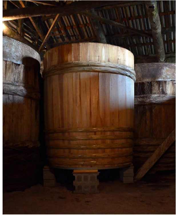
腕のよい大工 2 名とともに山本さん自らつくった新桶。仕込み用の大桶をつくれる職人は大阪に 1 人しかいないため、山本さんは弟子入りして桶づくりにも取り組む
