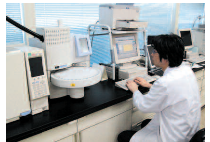
社内機関である日本エコロジ研究所では、飲料水の水質検査に特化した技術で水質分析を行っている。
