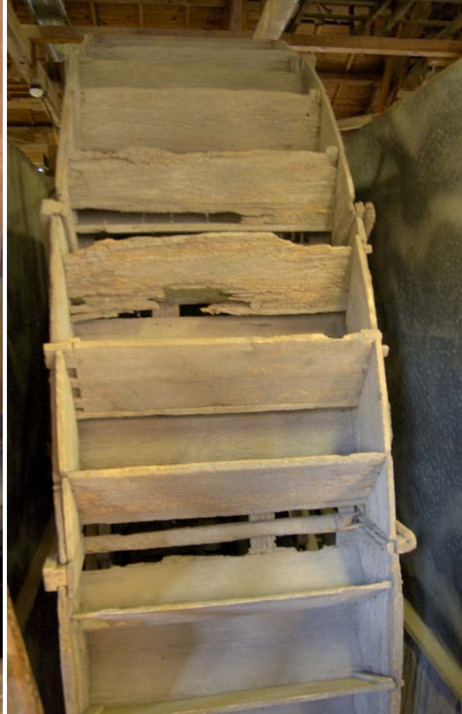
右から：水輪（みずわ）に使われる材は赤松。 ：水輪の回転を直角に変換している2つの歯車。一番トルク（回転力）のかかる部分だけに、大小2枚のギアを張り合わせた木製のベベルギア（傘歯車）を使っている。 ：水輪の反対側の稼働部分。手前から、篩（ふるい）挽き臼、4個の搗き臼。奥の壁にはパーツなどが整理して掛けてある。中央の挽き臼の左は、昇降機の動力を2階へ伝えるシステム。斜めの角材はドライブシャフトだ。 ：奥が水車システム。手前左は、電動モーターを動力にした精穀機。水車が止まった後も、電化して製粉業が続けられていた。
