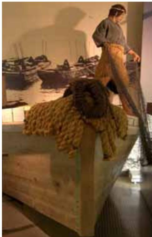
27ページ：右から織り網、ドブネ、大敷網の敷設模型。織り網は、魚が入る身網の部分に用いられ、指が入るぐらいの細かい目で編まれた。ドブネは、胴部分の断面が四角いことから「箱船」とも呼ばれ、大きなものは「ドブネ1ばい、家1軒」といわれるほど高価なものであった。模型は改良された「越中式締落とし網」のもの。
