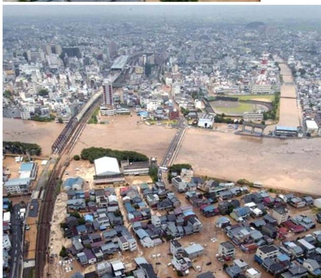
福井水害 足羽川・春日破堤地点 2004年7月18日。越流開始12：00頃、破堤13：35。越流から破堤までに95分かかっている。写真提供：朝日新聞社
