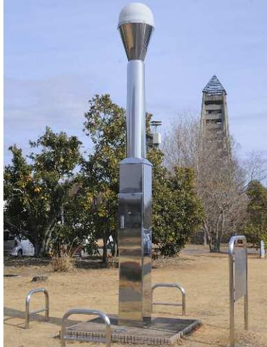
右ページは、(地図と測量の科学館)の屋外。右から、筑波基準点、電子基準点、筑波基準点を覆うコンクリート製のやぐら。三角点間を測量する際に目印として建てられるやぐらは使用後に撤去されるが、筑波基準点の場合は恒久的なものでコンクリートで建てられた。
