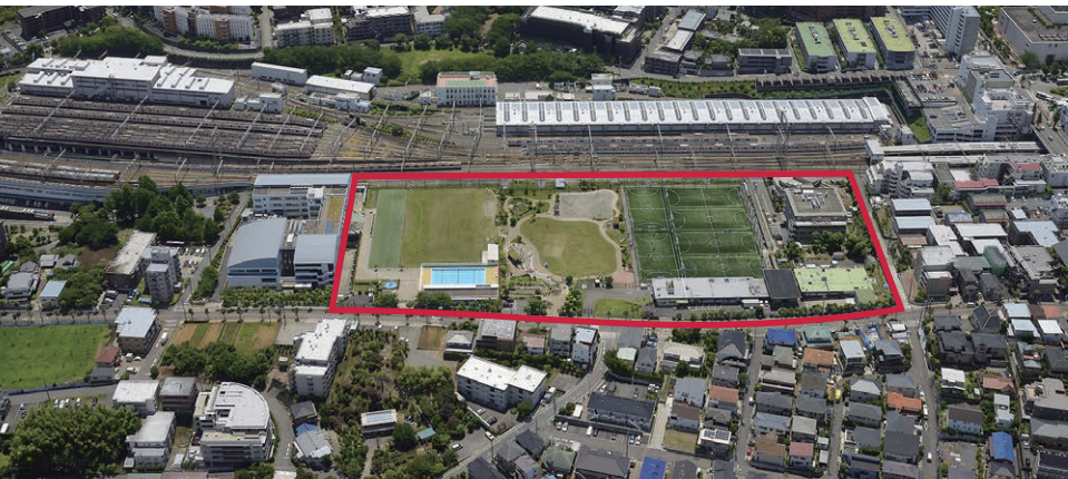
川崎市内最大の配水池「鷺沼配水池」（赤線で囲んだ部分）。フットサルコートなどの下に約11万トンの有効容量をもつ（提供：川崎市上下水道局）
