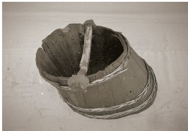
佐賀平野の泥土引き上げで使われた「ごみくいおけ」。2本の綱を二方向から引って張って引き上げる。より多くすくえるように歪んだ形をしている(提供:佐賀県農業試験研究センター)
