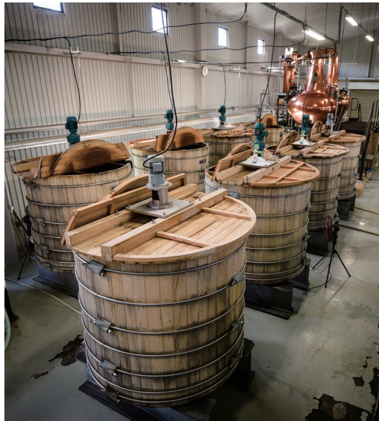
ベンチャーウイスキーの発酵槽。およそ4日間でもろみが出来上がる。全部で8基あるがすべて木製で、材はミズナラ。いずれも日本木樽木管株式会社(p22-25)が製作したもの
