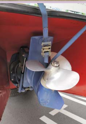
左：陸上を走るとき、スクリューはリフトアップされる。 下：公園の中の細い道を出入りするのだが、それも許可があつてのこと。普段は閉まっているゲートを開け閉めする必要がある。1日5便の運行で往復10回の開閉を、エンターテイメントを支える黒子がそつなくこなす。 左上：大川で真珠を育むイケテウ具。
