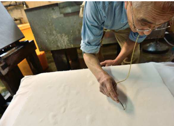
上右：MOは沖茂八さんの頭文字。石井柏亭さんの命名で、口ゴマークも描いてもらった。Nは透む性質の〈吸い込み〉を求めた中西利雄さんの頭文字。上中央：上から〈ドーサ引き〉と〈吸い込み〉と書道半紙の発色と透む具合。左：沖さんが漉くMO紙は、溜め漉き。繊維を一定方向に並べるのではないから、糞を揺ることはしない。水を切って重ねて置いたら、上から力をかけて水を絞る。空気が入って膨らんだ箇所は、チューブを吸って膨らみを消す。右下：茂八さんの開発したMO紙を継承する孫の桂司さんと奥さんの和美さん。
