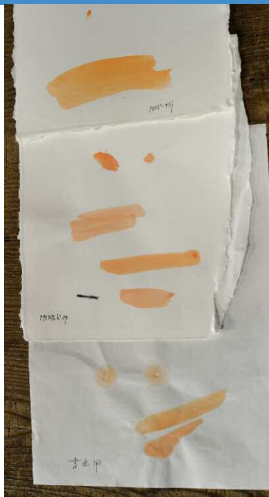
上右：MOは沖茂八さんの頭文字。石井柏亭さんの命名で、口ゴマークも描いてもらった。Nは透む性質の〈吸い込み〉を求めた中西利雄さんの頭文字。上中央：上から〈ドーサ引き〉と〈吸い込み〉と書道半紙の発色と透む具合。左：沖さんが漉くMO紙は、溜め漉き。繊維を一定方向に並べるのではないから、糞を揺ることはしない。水を切って重ねて置いたら、上から力をかけて水を絞る。空気が入って膨らんだ箇所は、チューブを吸って膨らみを消す。右下：茂八さんの開発したMO紙を継承する孫の桂司さんと奥さんの和美さん。
