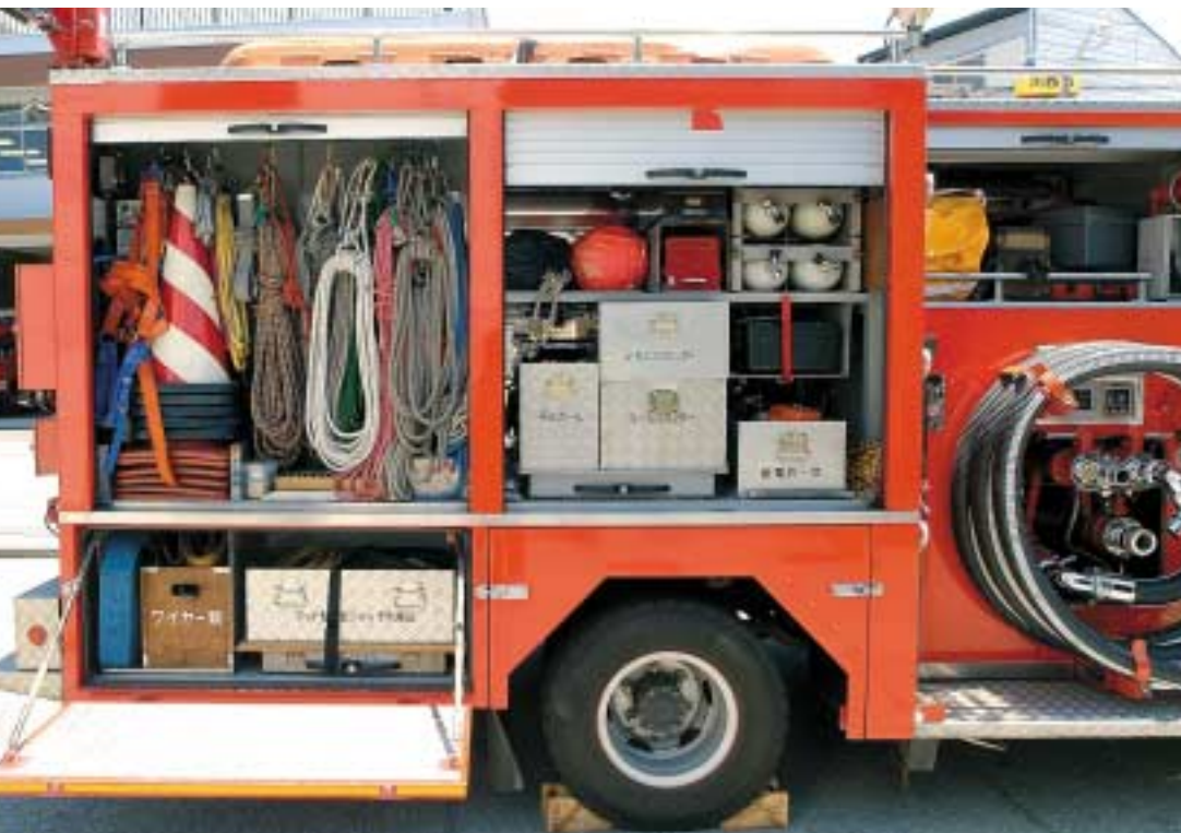
川西市のポンプ車の積み荷を見せてもらった。ドライバー側の積載品が、すべて救急（レスキュー）にかかわるものだったのには、驚かされた。消防の用具は、座席の背後とナビゲーター側に積まれていた。
