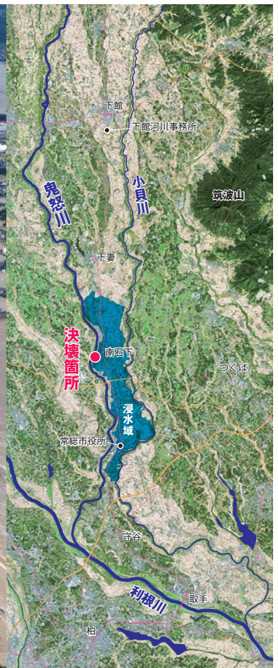
平成27年9月関東・東北豪雨によって鬼怒川の堤防が決壊した箇所と溢水域
