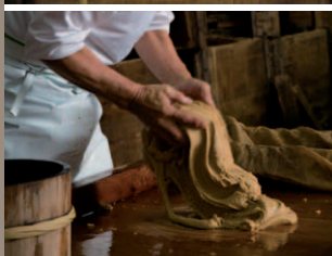
⑤ 一昼夜絞った白下糖を取りだし、手と水で研ぐ(蜜抜き「研ぎ」)。押しと研ぎを5日間繰り返したものをゆっくり乾燥させて完成
