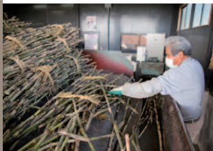
① サトウキビを細断して砂糖のエキスを取り出す
