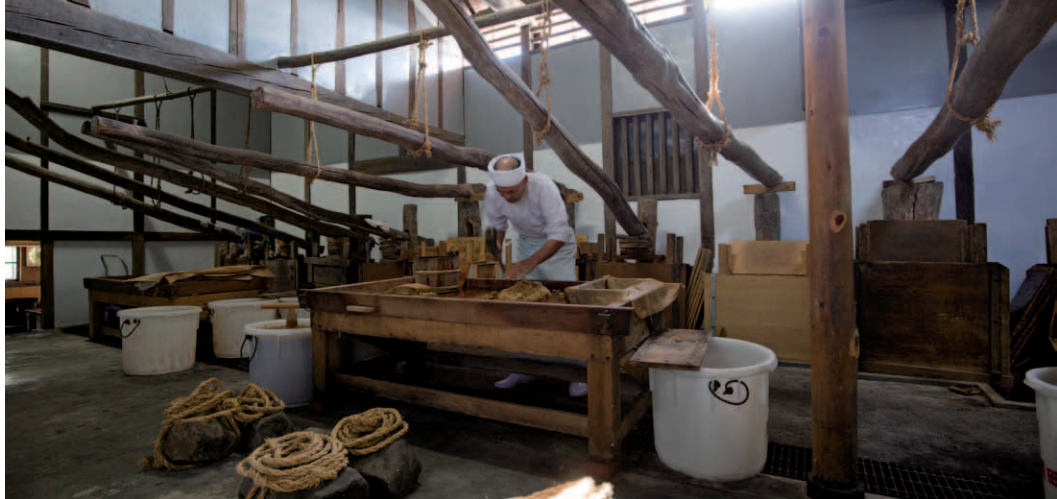
白下糖を白く精製する蜜抜き(押し・研ぎ)と乾燥の作業場。築年不明という古い木造蔵だ。和三盆を水で研ぐ職人・坂東永一さんを囲むように、てこの原理で蜜を絞る押し槽がある
