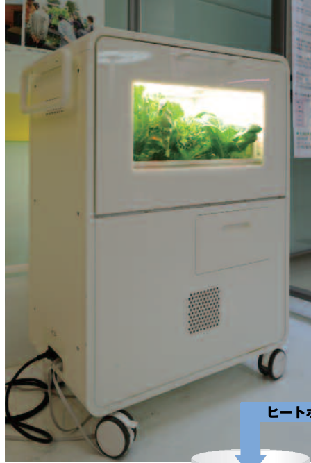
家庭用小型冷蔵庫ほどの大きさの小型植物工場装置。 下図は、閉鎖型植物生産システムで、水を循環させて利用する仕組み。
