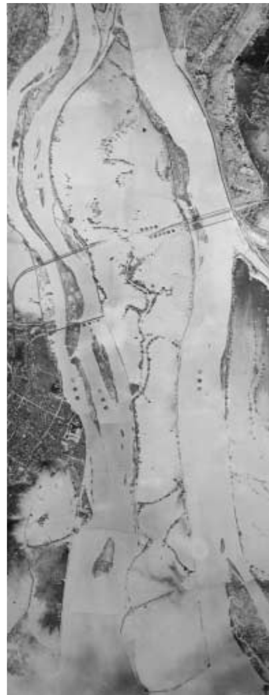
1959年(昭和34)9月26日伊勢湾台風が上陸。夜8時すぎに高潮、暴風雨が最高に達し、堤防が13カ所で欠壊。「どこか堤防が切れたら、堤防に逃げろ」の言葉通り、中堤が残った。 翌1960年より地盤沈下が急速に進行し、0m地帯はさらに広がった。このため排水設備の建設や堤防の強化改修が行われ、伊勢湾台風級の災害に耐えられるように備えた。
