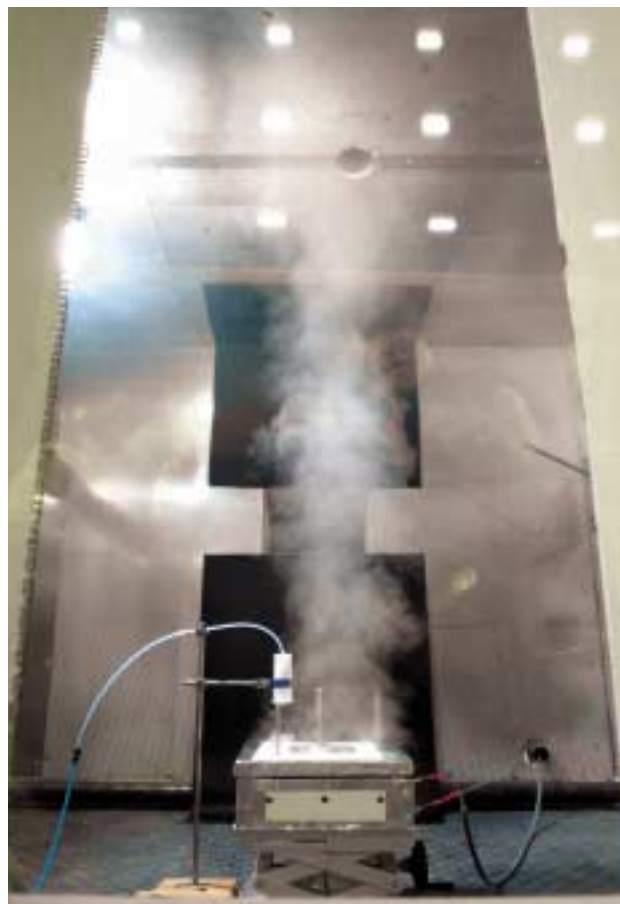
上：実験設備の閉鎖空間に、蚊取り線香で煙を溜め、熱した鉄板に放水した。瞬時に水蒸気が発生し上昇するとともに、天井近くに溜まっていた煙が下降するのが目視できた。実際の火災現場には、この何倍もの熱と煙が充満していると思うと、大変恐ろしくなる。
