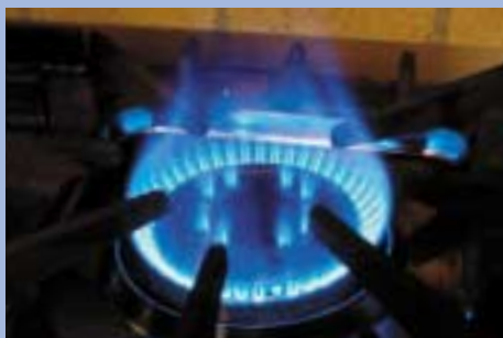
プロパンや都市ガスは常温で可燃性気体。コンロ機具の中で予め空気と混合させるから、青い整った炎の予混合燃焼。試しに空気調整弁を絞ると、拡散燃焼となりオレンジ色の揺らめく炎になる。
