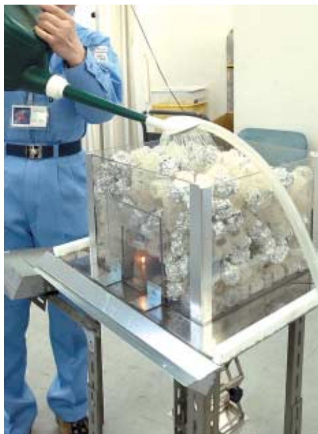
下：上面開放区画における、窒素ガス消火の実験。アルミホイルとプラスチックを堆積したゴミに見立て、下で燃えるろうソクを火災の炎と想定し、ジョウロで散水する。これだけでは炎は消えないが、ウォーターミストを加えた窒素をホースから注ぐと、ろうソクの炎を消すことができた。
