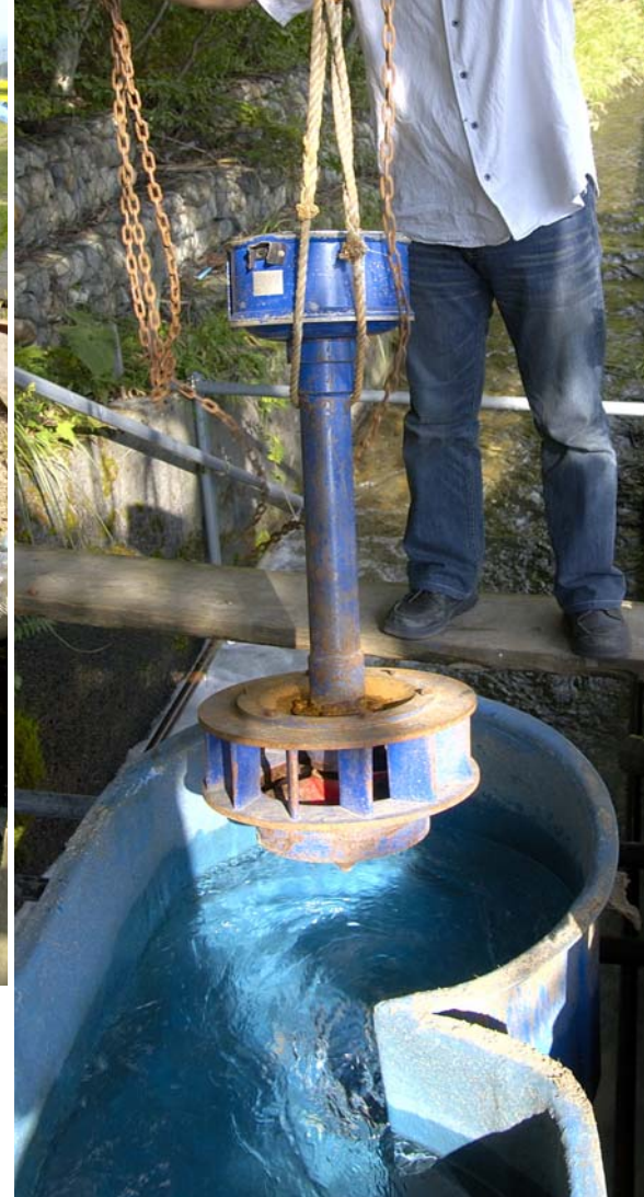
三面張りの用水路に設置された駒沢ミニ水力発電所。ベトナム製の発電機は渦巻く水でプロペラを回すタイプだ。プロペラの軸が垂直で、上部にある発電機ヘダイクトに回転を伝える。風呂桶のような青いバットの下にパイプが長く伸びているのは、落差をつくって水の位置エネルギーを取り出すため。発電された電気は、すぐ近くの畑の電気柵に用いられているが、発電機からの配線が少々心もとない。
